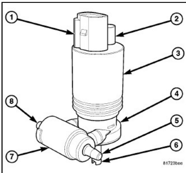
清洗器泵/电机单元由泵进水嘴和索环密封件之间的加固件固定至储液罐上，其为轻压配合，安装清洗器泵时可以不使用紧固件。电机罩顶部的整体式插头插座(1)通过一专门的取出装置和发动机舱线束插头将该组合体连接到车辆电气系统。
